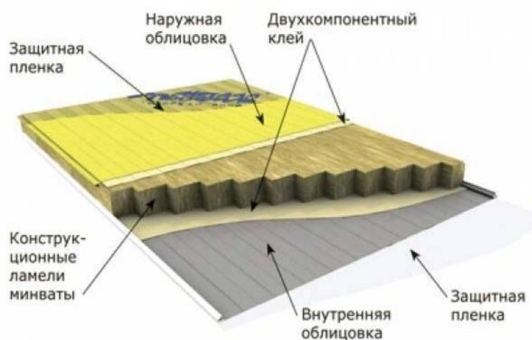
Рисунок 6 – Конструкция сэндвич-панели [7]
