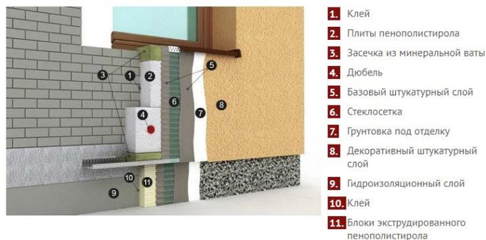
Рисунок 1 – Фасадная система Cerezit VWS
