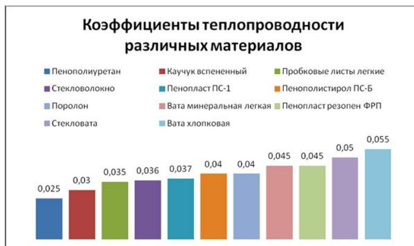
Рисунок 4 – Коэффициенты теплопроводности различных материалов
