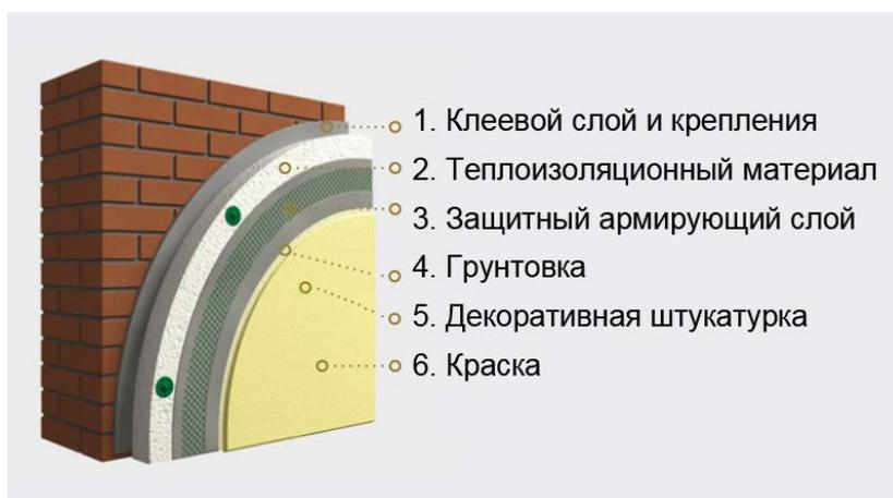
Рисунок 3 – Система утепления фасадов
