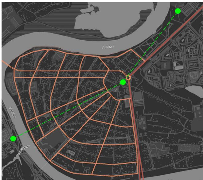
Рисунок 7 – Схема расположения посадочных пунктов и движения канатной дороги
