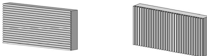
Рисунок 1 – Создание горизонтальных и вертикальных планок с помощью операции выдавливания
