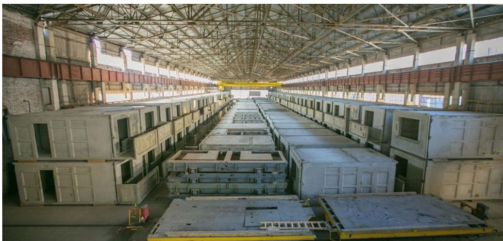
Рисунок 3 – Готовые Модули в заводских условиях
