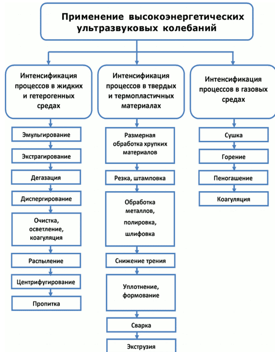
Рисунок 1.1 – Классификация применения ультразвука в промышленности
