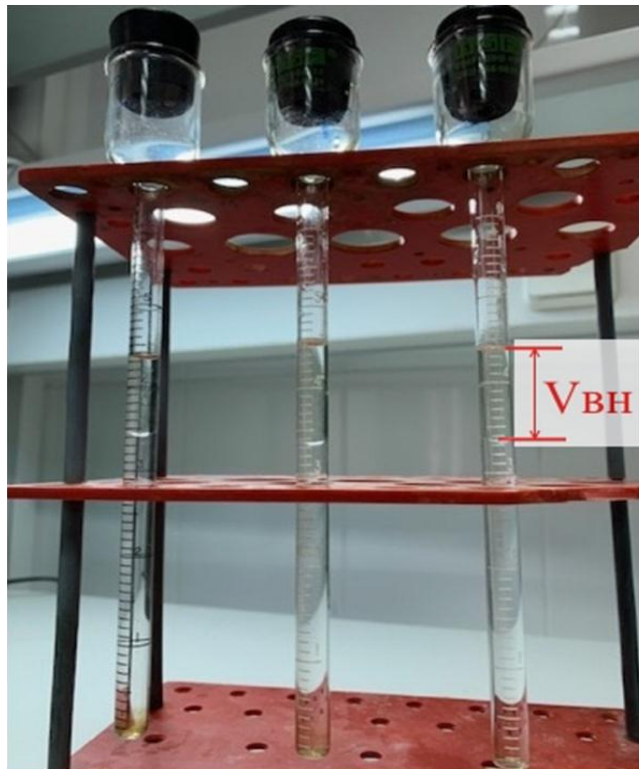
Рисунок 2.34 – Измерение объема вытесненной жидкости
