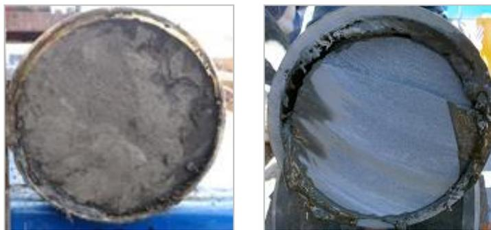
Рисунок 2.4 - Кернаприемные трубы с различными внутренними диаметрами
