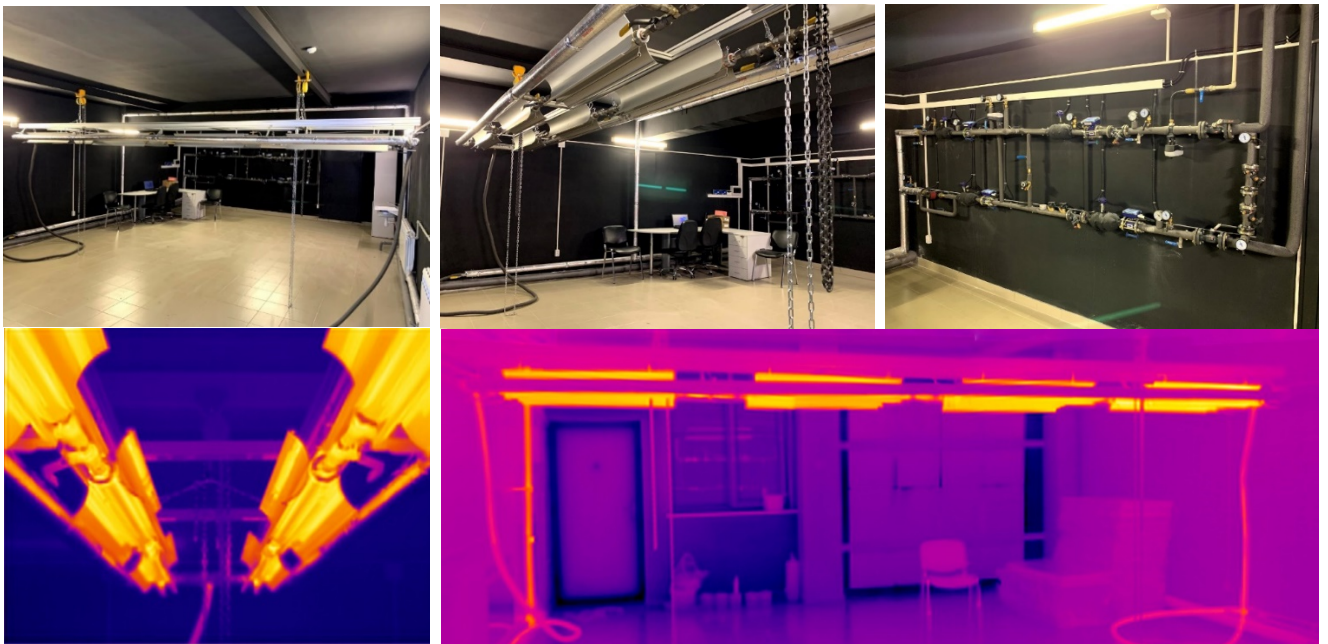
Рисунок 1 – Общий вид и термограммы Лаборатории лучистого отопления
