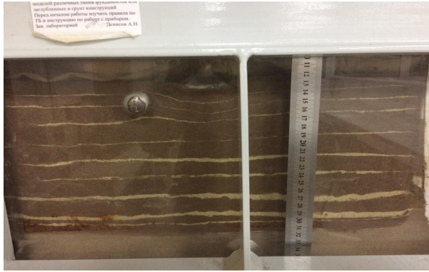
Рисунок 3.8 – Фото обратной засыпки в процессе нагружения
