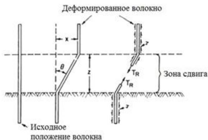
Рисунок 1.4 – Модель гибкого эластичного волокна в зоне сдвига (по Gray и Ohashi, 1983)
