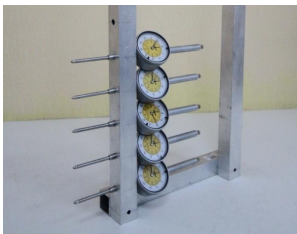
Рисунок 3.7 – Конструкция для измерения горизонтальных перемещений
