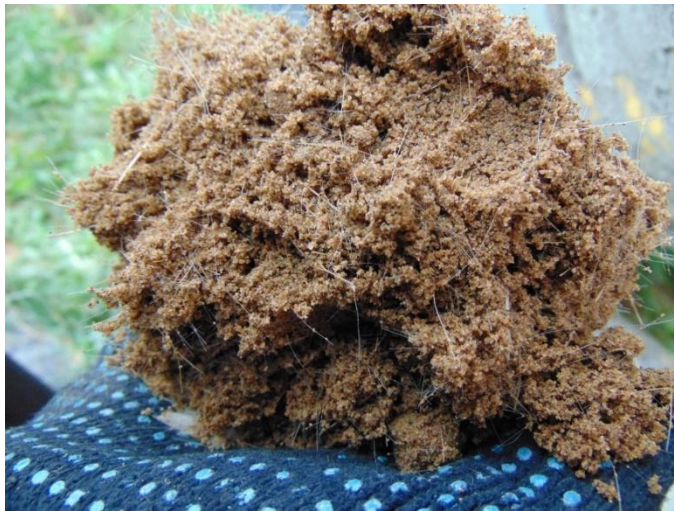
Рисунок 3.2 – Образец фиброгрунта, полученный в результате механизированного смешивания
