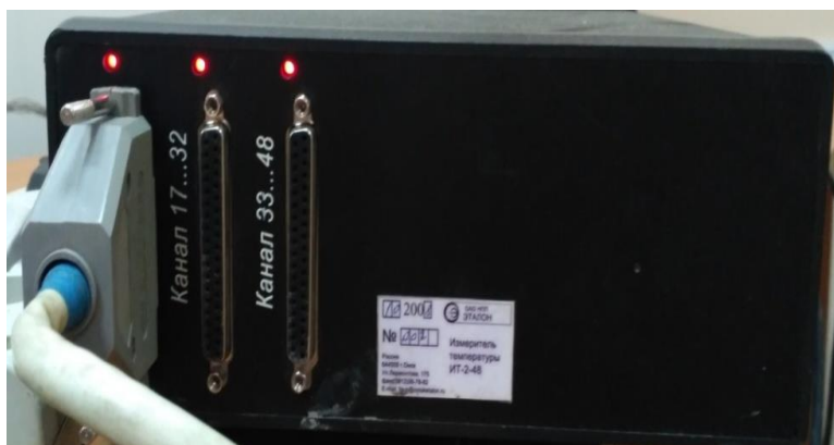
Рисунок 4.6 – Многоканальный измеритель температуры и теплопроводности ИТ-2-48
