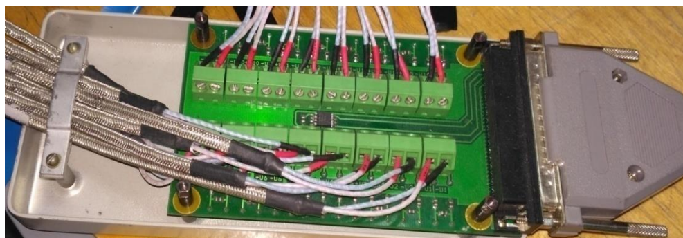
Рисунок 4.8 – Контролер для передачи данных с термоэлектрических преобразователей на многоканальный измеритель теплопроводности ИТ-2-48
