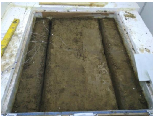
Рисунок 4.22 – Устройство продольных траншей в основании автомобильной дороги
