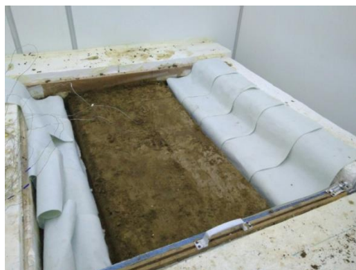
Рисунок 4.23 – Вертикальное размещение водонепроницаемого геосинтетического материала в продольных траншеях
