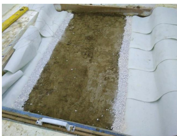
Рисунок 4.24 – Вертикальное размещение ГТМ в продольных траншеях
