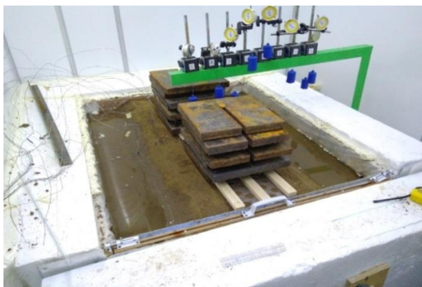
Рисунок 4.20 – Маломасштабный стенд моделируемых грунтов ЗП и многолетнемерзлого основания в период оттаивания для второго этапа эксперимента. Открытая система, при воздействии поверхностных вод и влиянии снежного покрова
