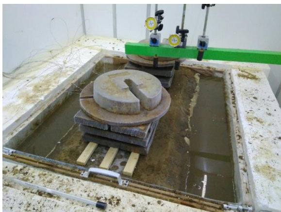
Рисунок 4.28 – Маломасштабный стенд моделируемых грунтов ЗП и многолетнемерзлого основания в период оттаивания для третьего этапа эксперимента
