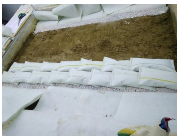
Рисунок 4.25 – Размещение под откосной частью насыпи ЗП ГТМ в водонепроницаемых геоконтейнерах
