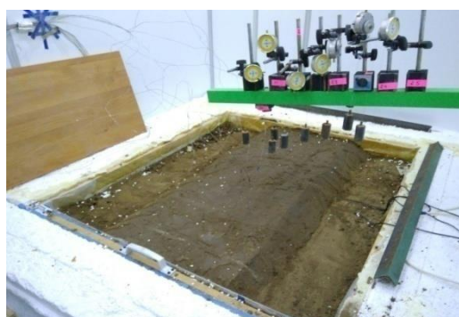
Рисунок 4.19 – Маломасштабный стенд моделируемых грунтов ЗП и многолетнемерзлого основания для первого этапа эксперимента. Закрытая система, без учета поверхностных вод и снежного покрова
