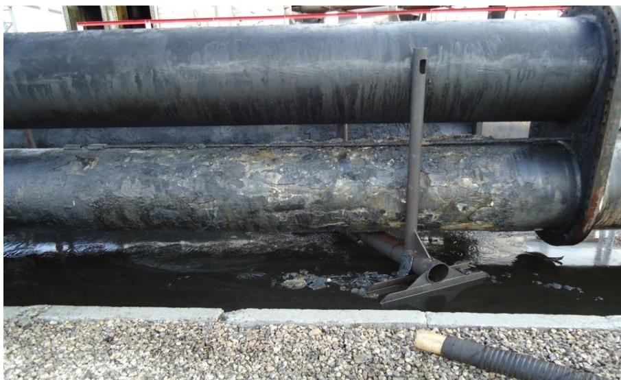
Рисунок - 4.1 Карбонатные отложения на жаровой трубе аппарата с прямым подогревом
