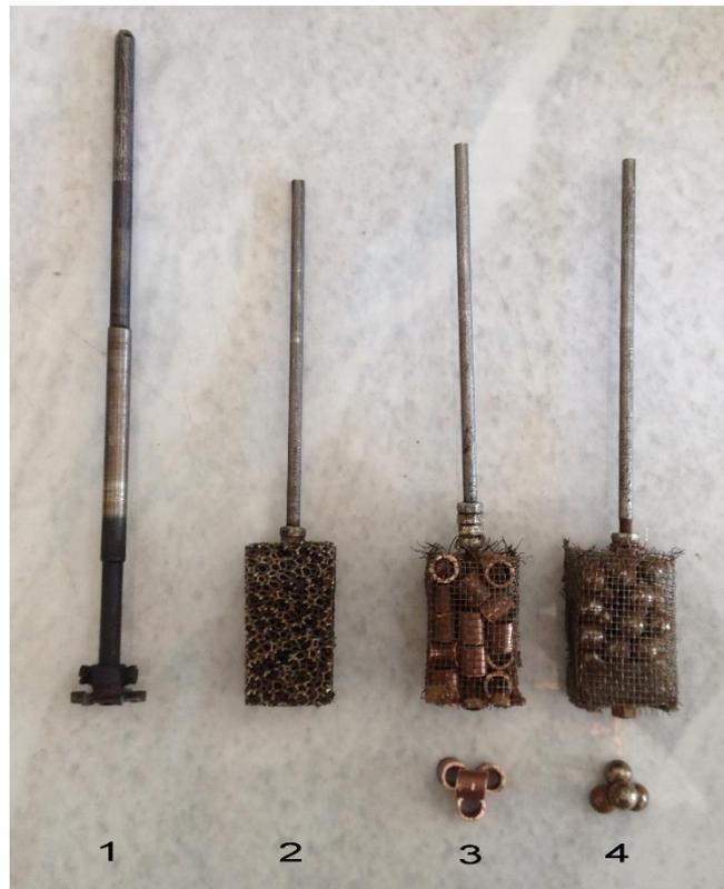
Рисунок 2.2 - Набор элементов для приготовления и дополнительной обработки эмульсии: 1 - 6-ти лопастная турбинная мешалка, 2 – коалесцирующая насадка «пеноникель», 3 – насадка «контейнер» с нерегулярной загрузкой колец Рашига, 4 - насадка «контейнер» с нерегулярной загрузкой из металлических шариков диаметра  $D=6$  мм.
