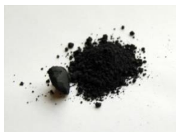
Рисунок 4.2 – Оксид марганца (IV) MnO_2 : а – фракции диоксида марганца 0,7-1 мм для загрузки в опытный образец; б – диоксид марганца в фильтре
