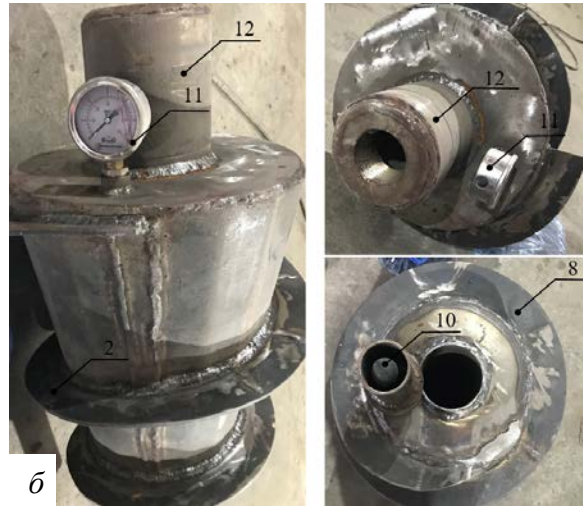
Рисунок 7 – Общий вид устраиваемой сваи (а) и «тампоной обоймы» (б): 1 – основание, 2 – скважина, 3 – анкерные тяги, 4 – долото, 5 – соединительная муфта, 6 – «тампоная обойма», 7 – корпус обоймы, 8 – реборда, 9 – металлическая трубка с маслом, 10 – мембрана, 11 – манометр, 12 – труба, 13 – внутренняя коническая резьба, 14 – буровые винтовые лопасти, 15 – тело сваи
