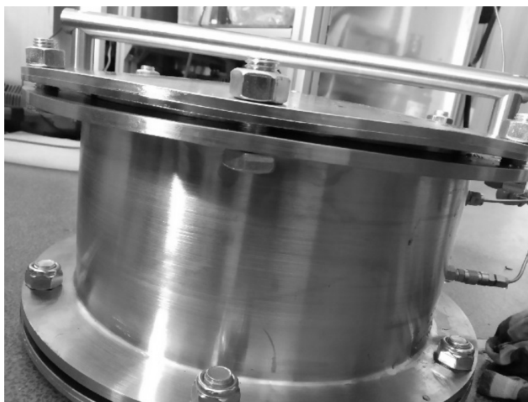
Рисунок 1. Деформация крышки капилляриметра
