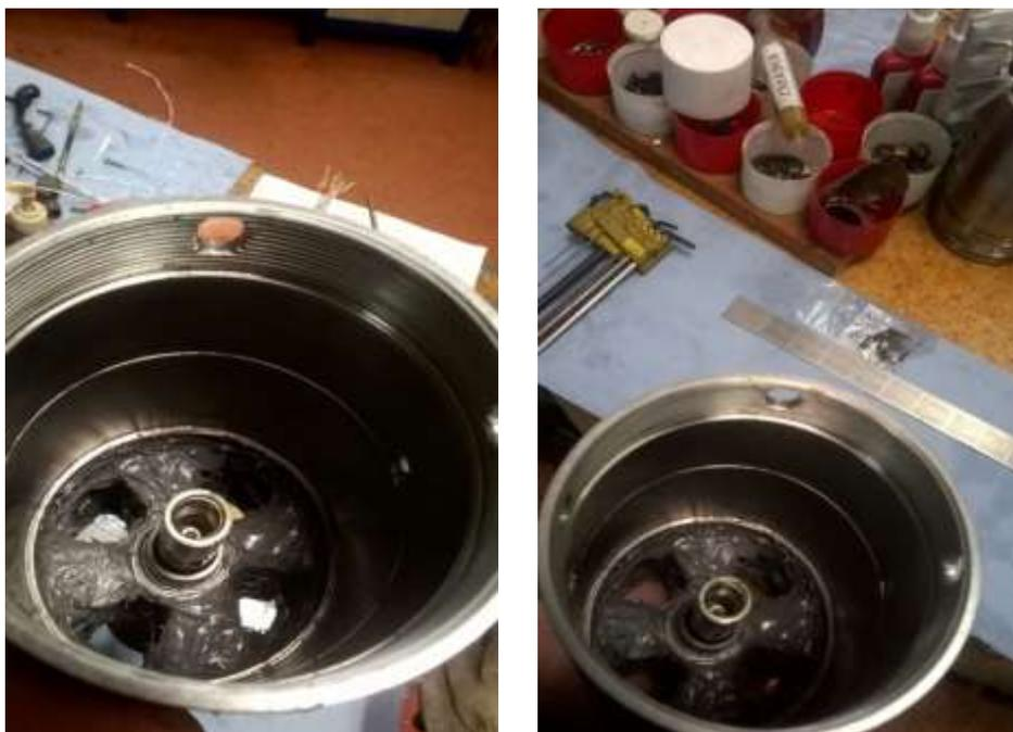
Рисунок 4. Обработка стакана пульсатора металлополимером WEICON
