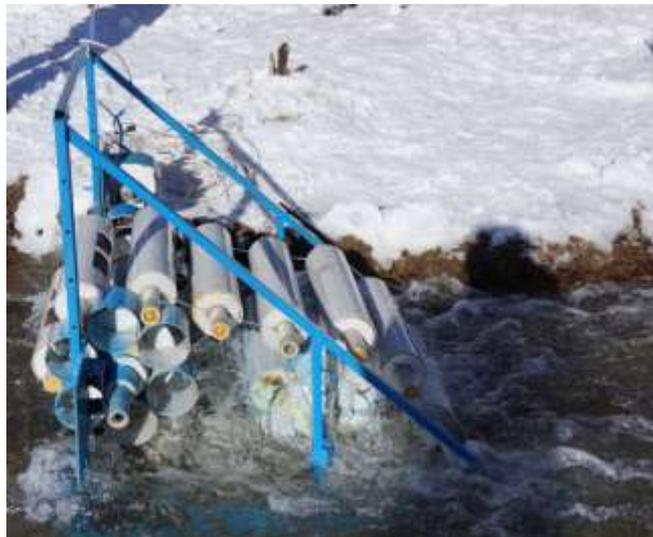
Рисунок 2. Продольнопоточная микро ГЭС в рабочем состоянии
