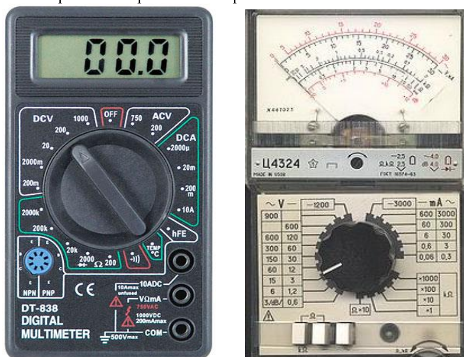
Рис. 2.1. Цифровой и аналоговый мультиметры
