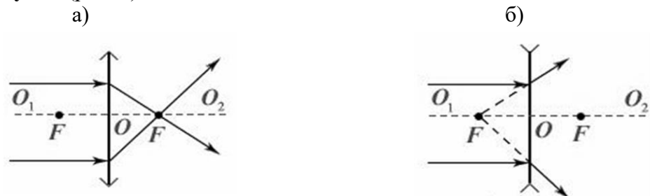
Рис. 4. Действие линз и их условное обозначение
