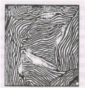
Рис.6 Схема микроструктуры заэвтектического белого перлитного серого чугуна
