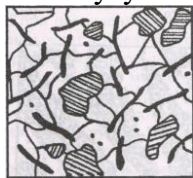
Рис.7 Схема микроструктуры ферритно-перлитного серого чугуна.
