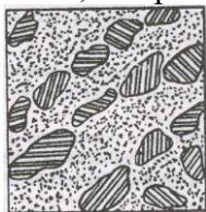
Рис.2 Схема микроструктуры доэвтектического белого чугуна Ледебурит и перлит
