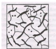
Рис. 5 Схема микроструктуры чугуна.
