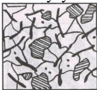
Рис.7 Схема микроструктуры ферритно-перлитного серого чугуна.
