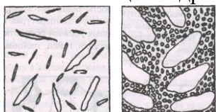
Рисунок 4. Схема микроструктуры силумина марки АЛ2 до модифицирования Микроструктура сплавов на основе меди
