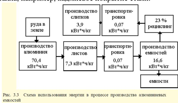
Рис. 3.3 Схема использования энергии в процессе производства алюминиевых емкостей
