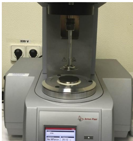
Рисунок 2.23 – Реометр Modular Compact Rheometer MCR52 (Anton Paar GmbH, Austria)
