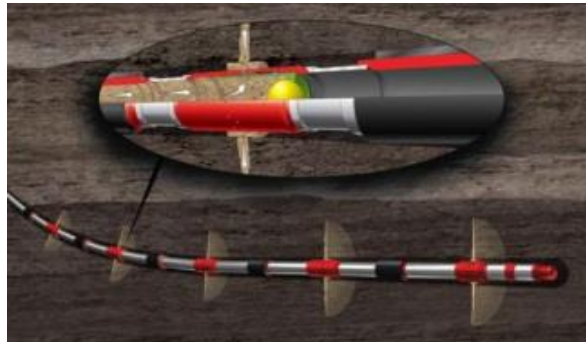
Рисунок 1.20 – Технология многостадийного гидроразрыва пласта в горизонтальной скважине
