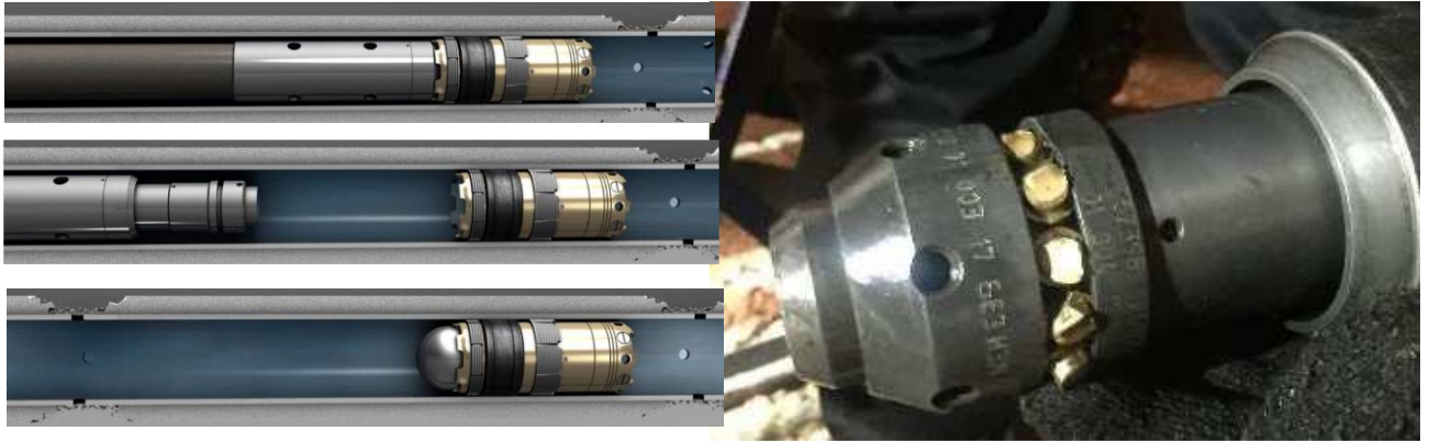
Рисунок 3.3 – Системы заканчивания скважин с горизонтальным окончанием с «глухой» обсадной колонной и перфорацией
