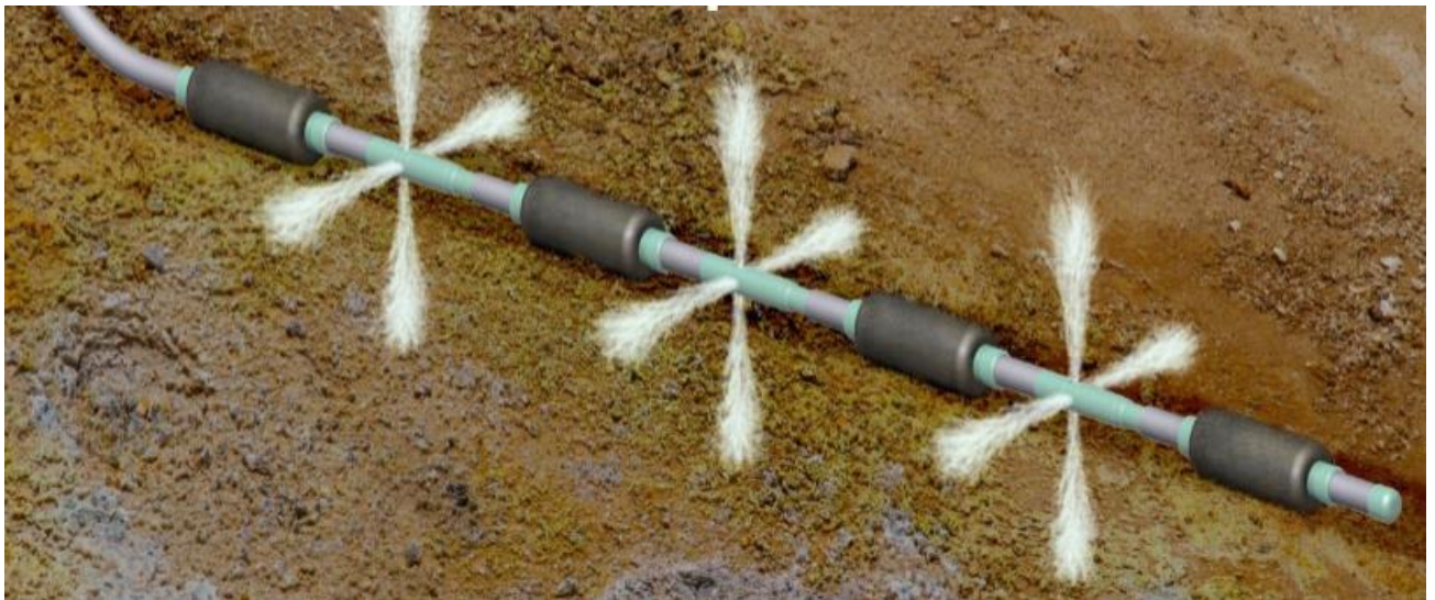
Рисунок 3.9 – Схема надувных пакерных систем компании Пакер Сервис. Коммерческое название RITTS™
