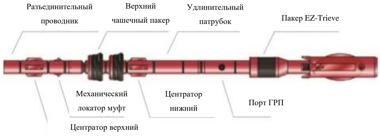
Рисунок 3.8 – Схема двухпакерной компоновки компании ООО «Трайкан Велл Сервис». Коммерческое название C2C™ (Cup-to-cup)
