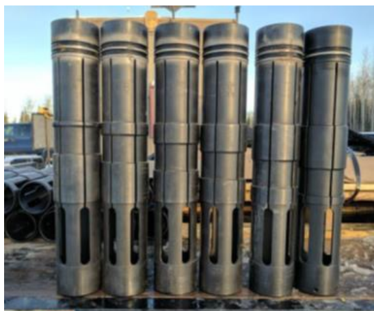
Рисунок 3.11 – Технология проведения повторного МсГРП в скважинах с горизонтальным окончанием с помощью втулки-ключа
