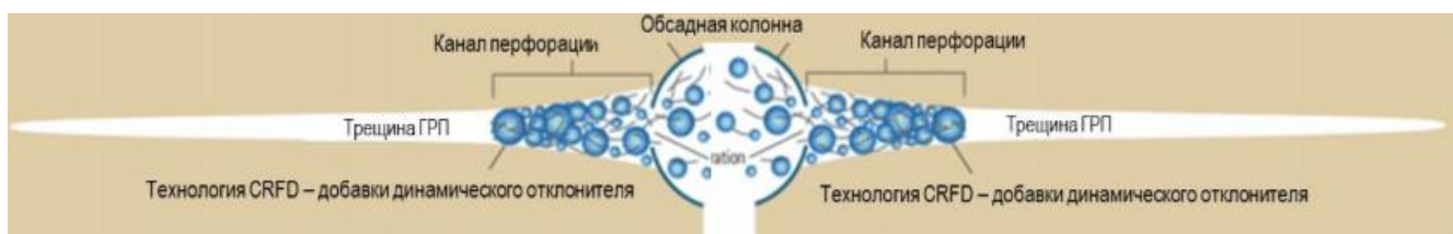
Рисунок 3.10 – Проведение повторного МсГРП в скважинах с горизонтальным окончанием с применением динамического отклонителя компании Shlumberger.
