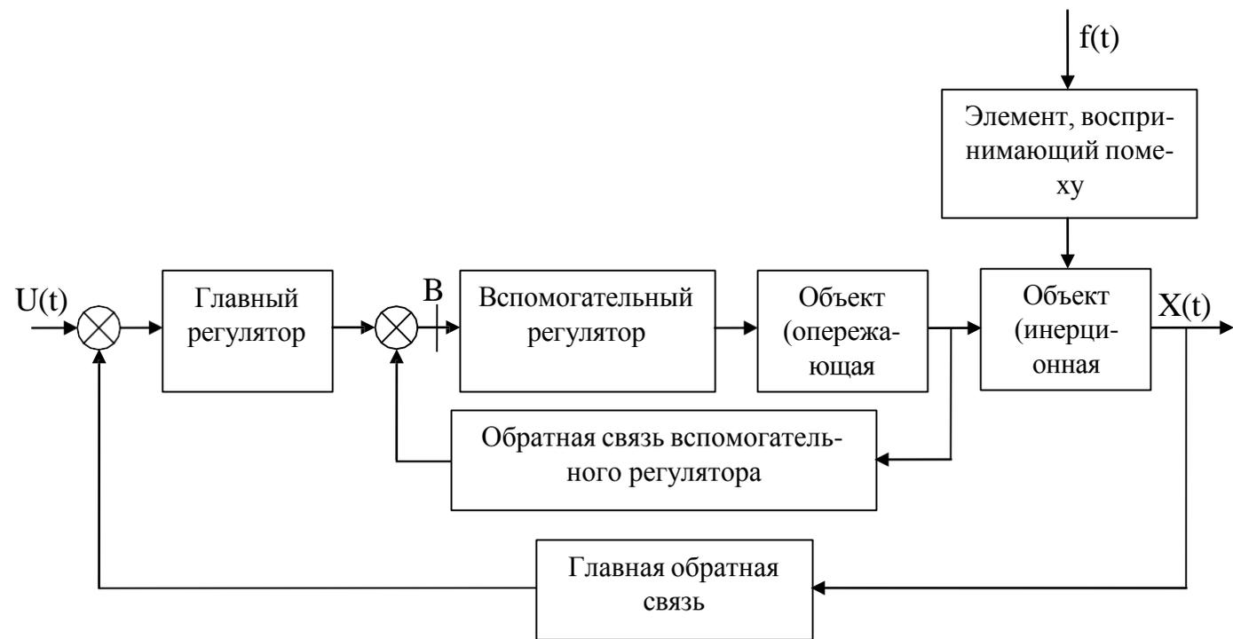
Рисунок 1. Структурная схема системы каскадного регулирования
